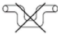
Zbyt wiele gięć przewodu wentylacyjnego
